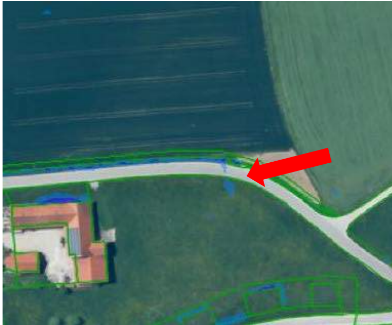
Bild 36: Regenwasserüberlauf aus dem Straßengraben Salinger Straße
