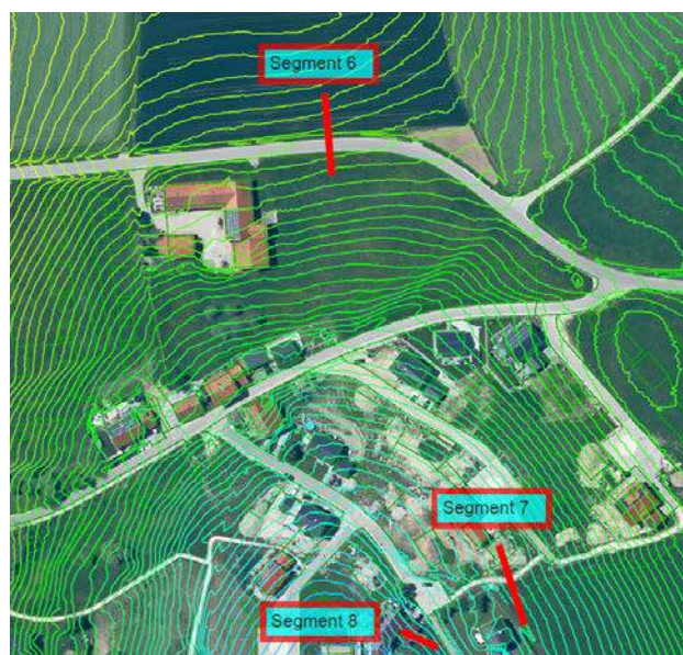
Bild 34: Segmente zur Bestimmung von Teilabflüssen
