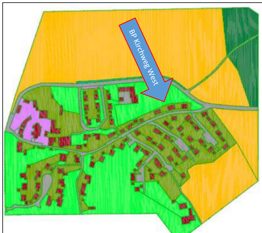
Bild 29: Verwendete Oberflächenrauheit im Berechnungsmodell
