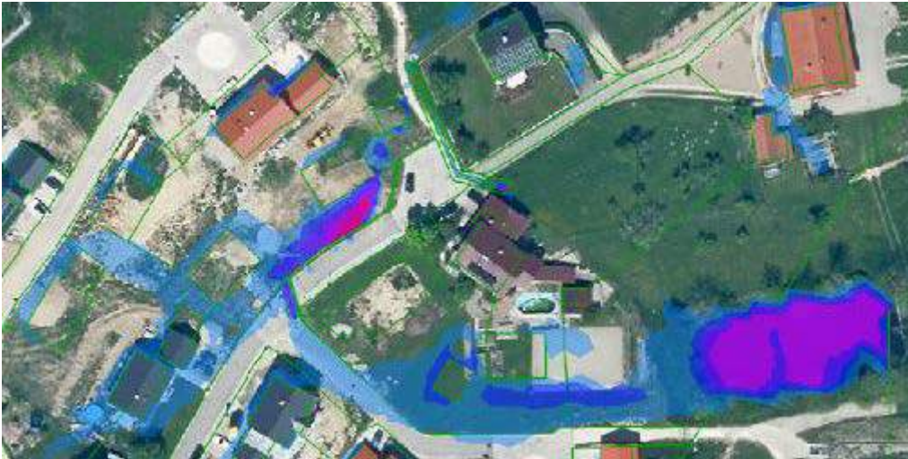
Bild 42: Regenwasser aus Bauparzellen oberhalb der Blasiusstraße
