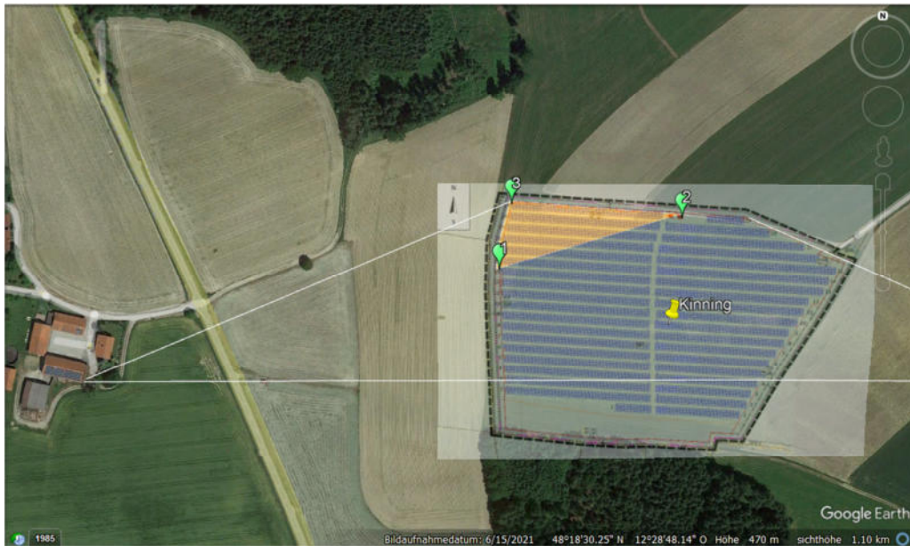
Abbildung 10: möglicher Emissionsbereich für Immissionsort 2 – Dirnlech 1; [Quelle: Google Earth, eigene Berechnungen]
